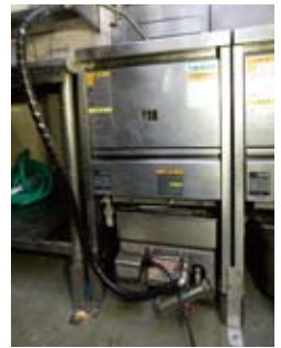
小型食用油精製装置。フライヤーの下に設置できる省スペース設計です。ホースをつないで油を循環させます。
